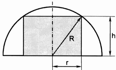
3.1 Ermitteln Sie die Maßzahl  $V(h)$  des Volumens des Zylinders in Abhängigkeit von der Höhe  $h$  und geben Sie eine sinnvolle Definitionsmenge für die Funktion  $V : h \mapsto V(h)$  an, wenn die Höhe  $h$  mindestens 6 cm betragen soll. (4 BE)
